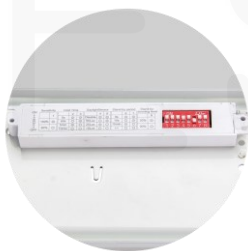
Capteur MVS interne avec Dip-switch
